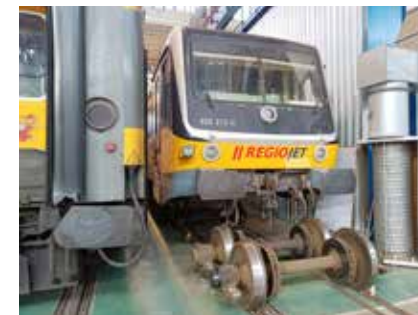
Takto vypadá „tříletá prohlídka“, při které je rozebrán i podvozek
